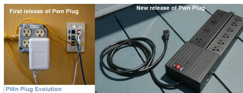
集成了Wi-Fi、3G、以太网等功能的渗透测试用插线板 (图片来源: http://securityaffairs.co )
